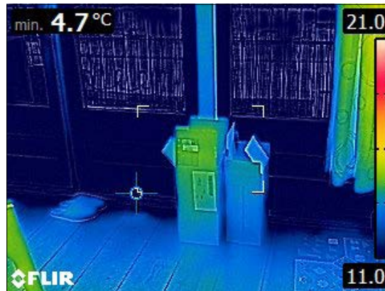
De openslaande deuren in de bovenwoning aan de noordzijde. De beglazing vormt in deze ruimte een koude wand.
