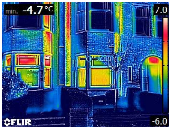
Verschillende kwaliteiten glas, enkel glas (in rood) en regulier dubbel glas (in geel/groen). Door reflectie van de lucht is de kwaliteit van het glas op de verdieping moeilijk in te schatten.
