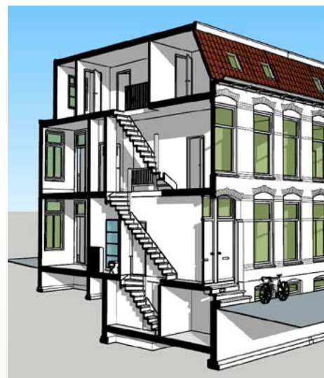
Doorsnede van een boven- en benedenwoning
